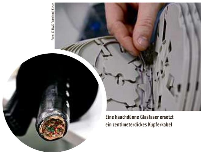
Eine hauchdünne Glasfaser ersetzt ein zentimeterdickes Kupferkabel
