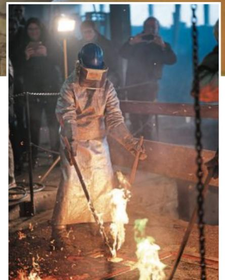
Hier wird 1.100 Grad heiße Bronze in die eingemauerte Glockenform gefüllt.
