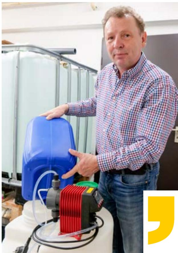
Im Verhältnis 1:1000 wird Alwin Sperlings Mittel dem Trinkwasserkreislauf zur Desinfektion beigemischt.
