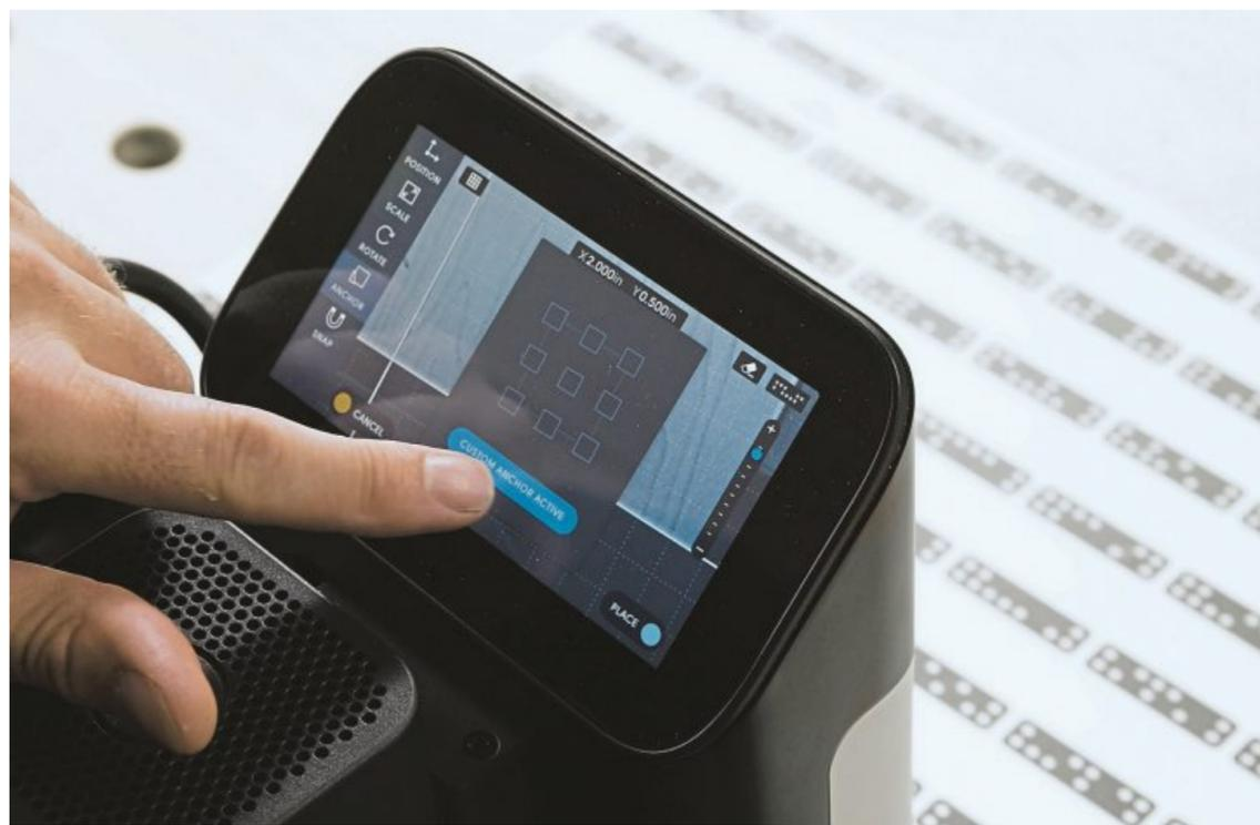
Bei der Handfräse Origin von Shaper kann der Fräspfad dank On-Tool-Designsoftware direkt auf dem Touchscreen angelegt werden.
