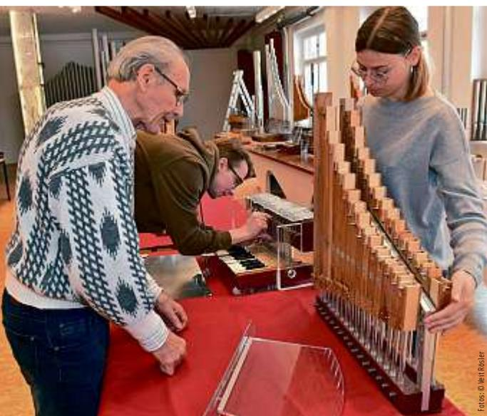
Die Hauptkomponenten der vier Mini-Orgeln können systematisch in ihre Hauptsegmente zerlegt und auch wieder zusammengesetzt werden. Geübte Hände benötigen dafür etwa fünf bis zehn Minuten. Das Konzept ermöglicht es auch, dass die Kinder die neu entstehenden Orgeln ebenfalls nach simplen Grundsätzen nach Richtung oder Stimmgerät selber stimmen können.
