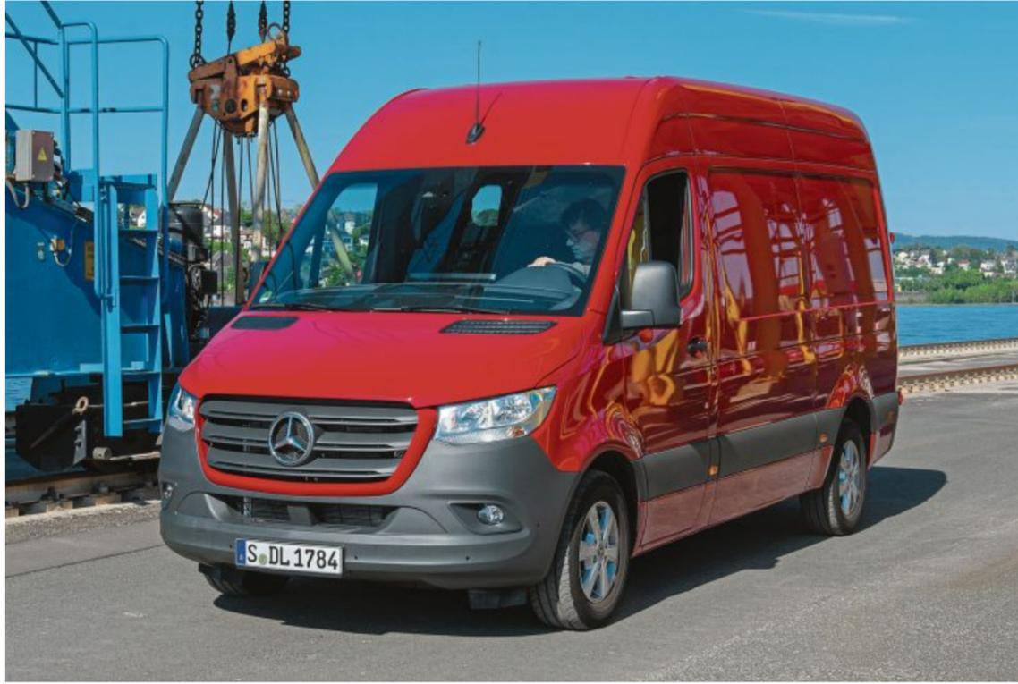
Der Mercedes-Benz Sprinter 315 CDI mit Frontantrieb hat den Vorteil, dass die Ladekante bei geschlossenen Varianten um 80 Millimeter niedriger ist.
