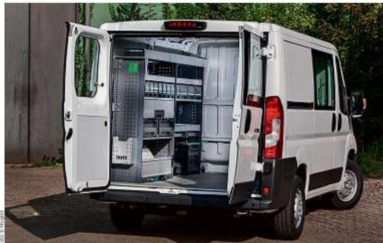
Im Handwerk üblich: Nutzfahrzeuge mit Auf- oder Innenausbauten – hier der Peugeot Boxer – mit Bott-Ausbau.
