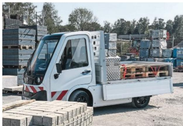
Dank des sogenannten EasySwap-Systems lassen sich die Aufbauten des Able XT schnell austauschen.
