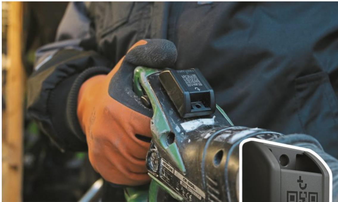
Das Werkzeug fest im Griff und jederzeit auffindbar – dank eines kleinen Tracking-Tools.
