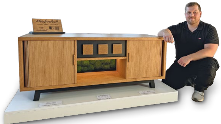
Marco Wendelmuths TV-Lowboard aus massiver Eiche, schwarzer CDF-Platte und klassischen Holzverbindungen beinhaltet einen verdeckten Schließmechanismus und ist von allen Seiten ein echter Hingucker
