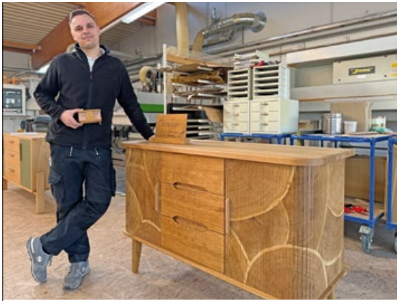
Marius Tepper verarbeitete das aus Österreich beschaffte Hirnholz-furnier mit dem Skalpell, um bei den Rolltüren die hinreißende Optik seines Eichensideboards mit Geheimfach zu erhalten.
