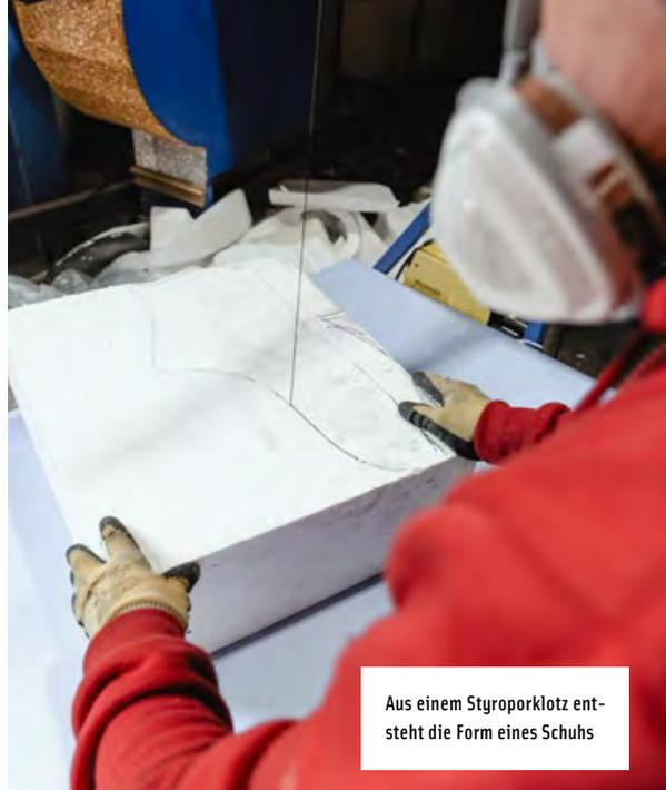
Aus einem Styroporklotz entsteht die Form eines Schuhs
