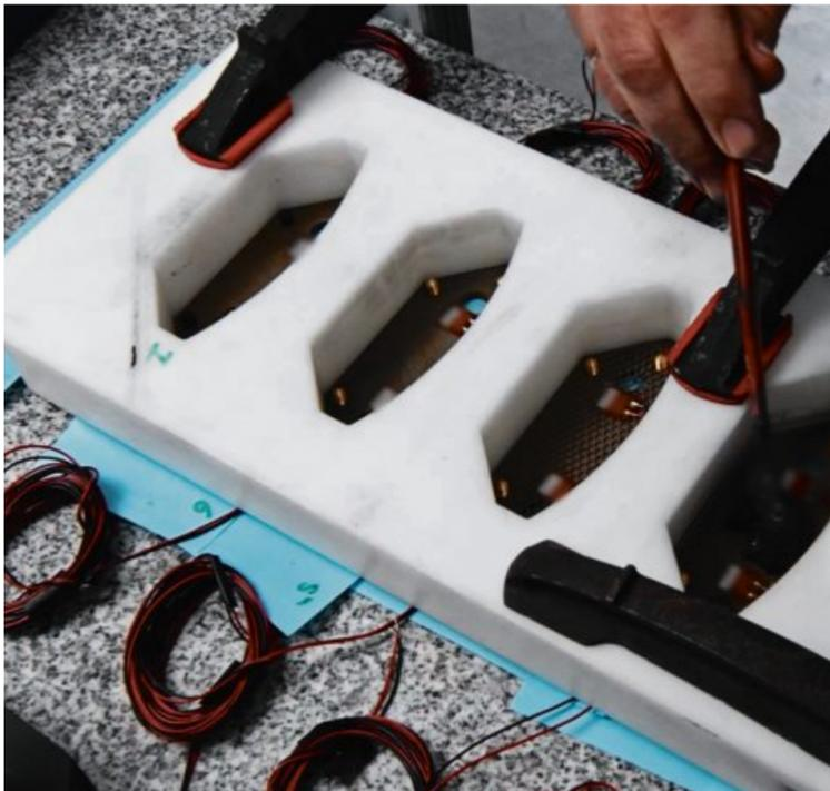
Dank der speziellen Art, „intelligente“ Reibbeläge herzustellen, können Sensoren in der Flüssigphase integriert werden.
