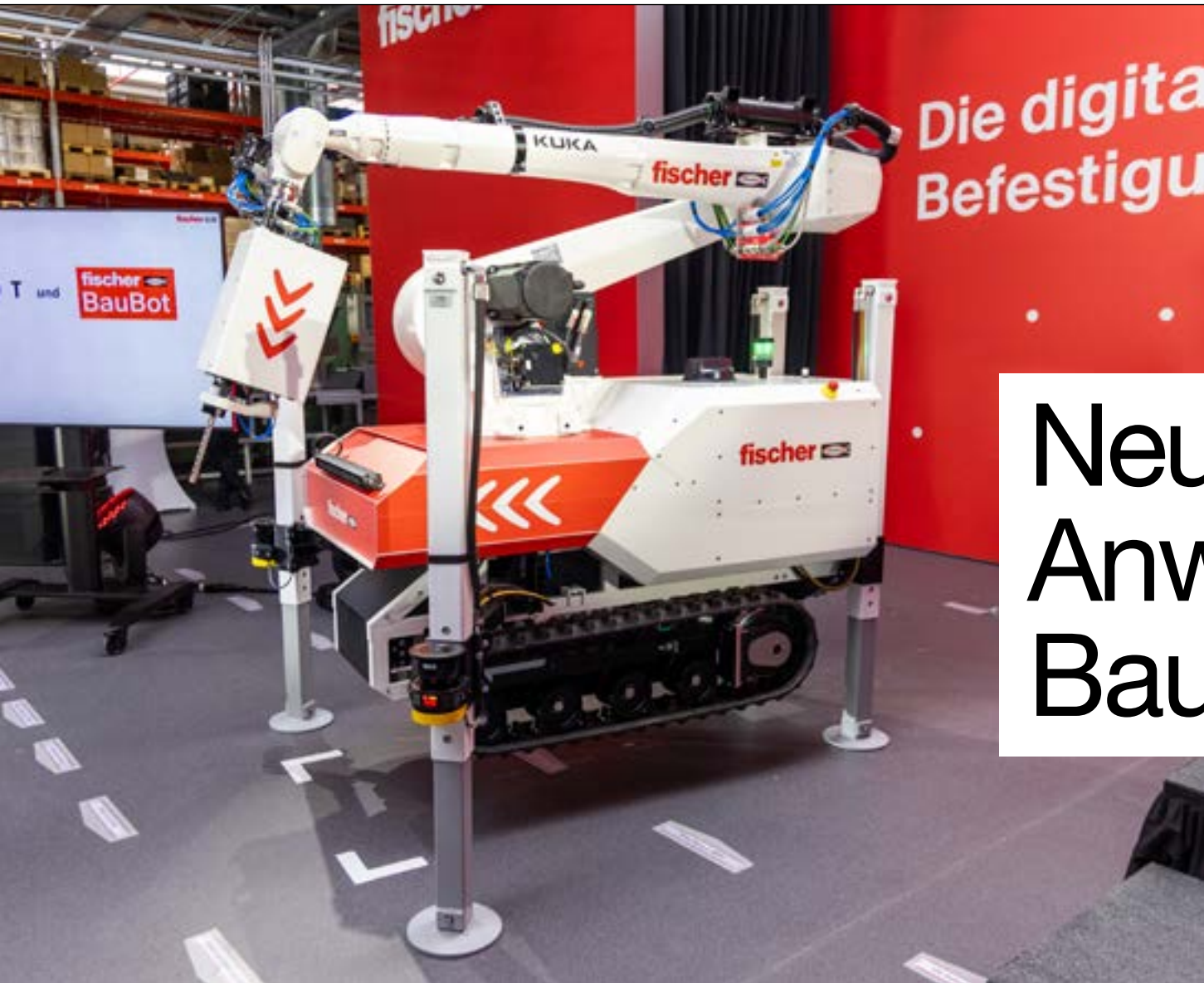
Der BauBot soll vor allem auf Großbaustellen zum Einsatz kommen.
